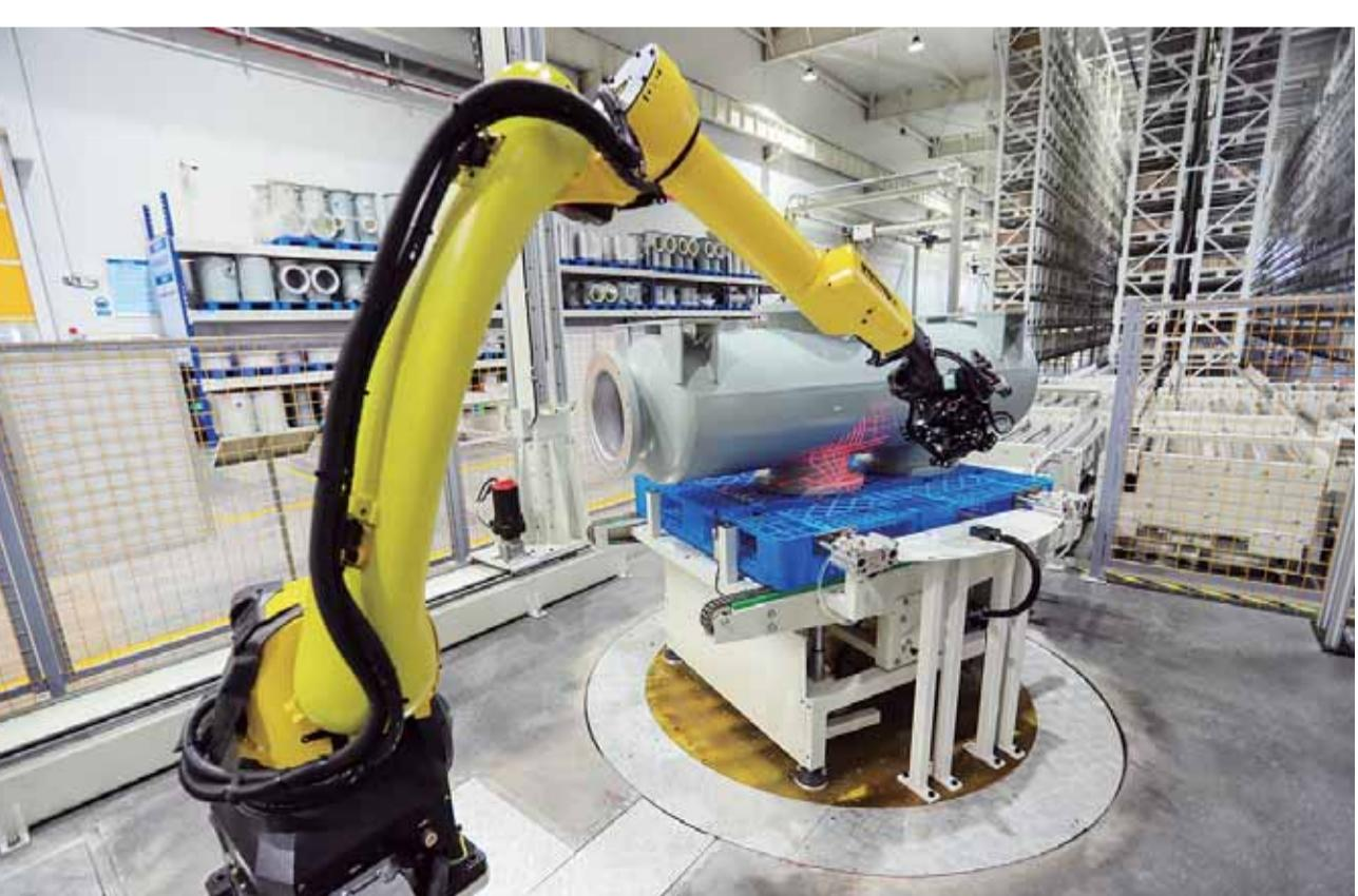
4月8日，特变电工云集5G科技产业园生产车间内，三维成像自动检测线正在检测设备部件。据了解，该园区上线依托5G应用技术的八大工业信息系统联动设备，使得工厂的技术工艺水平、生产全过程控制能力得到大幅提升。据统计，这套系统使工厂研制周期缩短超20%、生产效率提升超25%。（详见第八版）
