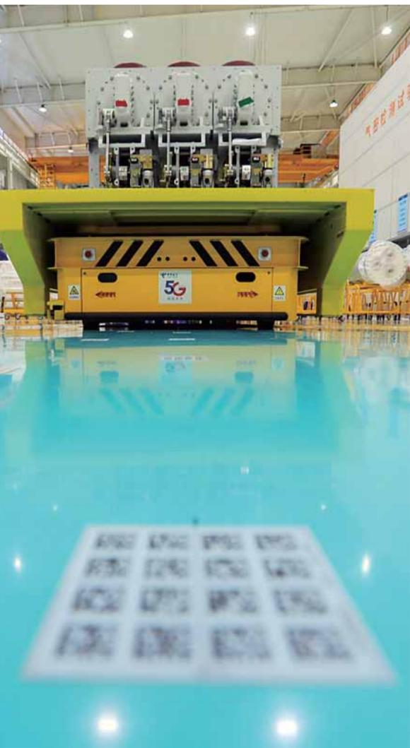
依靠地面上的引导码,重载AGV小车能精准安全运送产品
