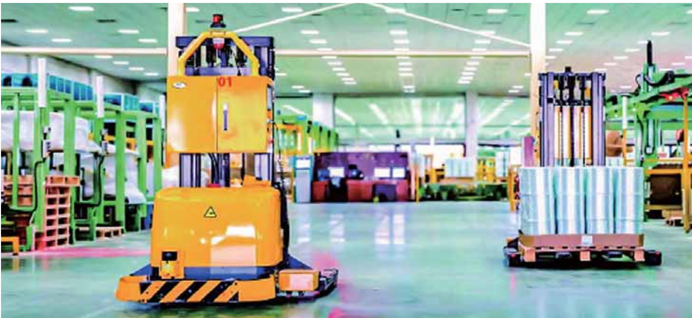
检装车间AGV小车正在自动运输纱团
