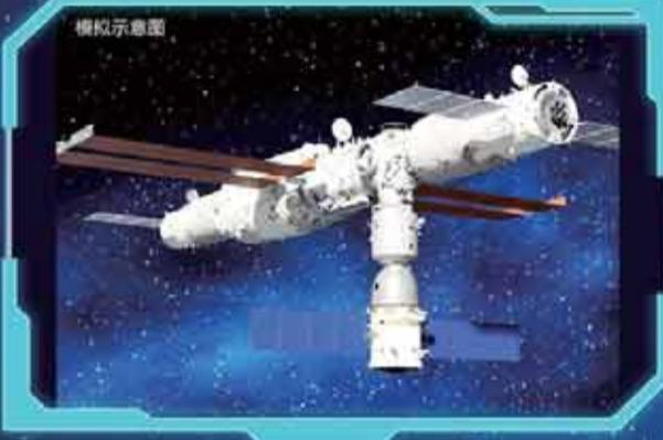
神舟十三号载人飞船采用自主快速交会对接模式成功对接于天和核心舱径向端口，此前已对接的天舟二号、天舟三号货运飞船一起构成四舱（船）组合体，整个交会对接过程历时约6.5小时。
